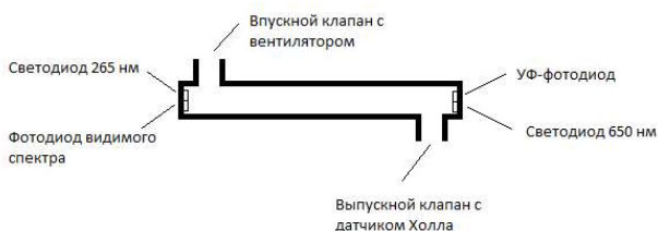
Рис. 2. Принципиальная схема детектора озона.
